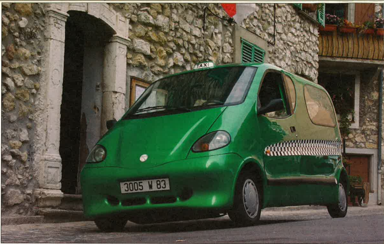
MDI levert twee modellen, hier de Citycat, uitgerust met airbags, airconditioning en zes stoelen. De auto weegt 750 kilo en rijdt maximaal 110 km/u
